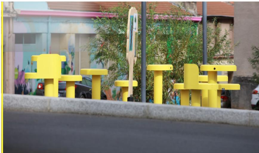
Le module de base de la solution est composé d'un coussin d'assise de forme oblongue en fonte d'aluminium peinte, de dimensions 400 x 600 mm, d'une jupe et d'un pied en acier zingué peint.
